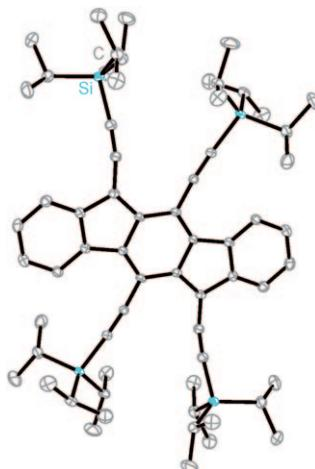
**Eine weitere Wahl:** Vollständig konjugierte, formal antiaromatische Indeno[1,2-b]fluorene (siehe Struktur) wurden aus den entsprechenden Dionen durch eine SnCl<sub>2</sub>-vermittelte Reduktion synthetisiert, die häufig zur Erzeugung von Acenen eingesetzt wird. Die Ergebnisse optoelektronischer Studien belegen, dass Indenofluorene die üblichen Acene wie Pentacene in Materialienanwendungen ersetzen könnten.
