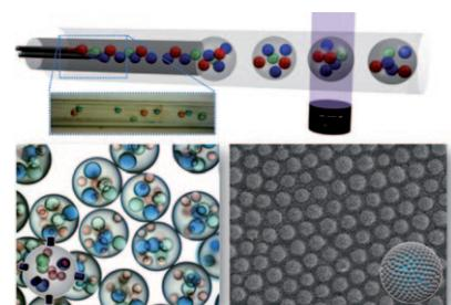
**Signalverstärker:** Superparamagnetische Partikel-Antikörper-Konjugate ermöglichen den Nachweis eines Krebs-Biomarkers in Serum durch Oberflächenplasmonenresonanz (SPR) in einer beispiellos niedrigen Konzentration von  $10 \text{ fg mL}^{-1}$  (ca.  $300 \text{ am}$ ). Die ultrahohe Empfindlichkeit resultiert aus der zusätzlichen Masse und dem höheren Brechungsindex von Aggregaten  $1 \mu\text{m}$  großer magnetischer Partikel (MPs) auf dem SPR-Chip.
