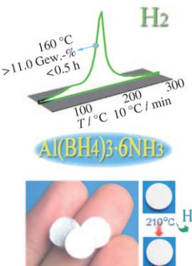
Al(BH<sub>4</sub>)<sub>3</sub>·6NH<sub>3</sub> wurde auf einfachem Weg hergestellt und seine Komposite können bei <140°C mit günstiger Kinetik mehr als 10 Gew.-% Wasserstoff durch die schwach exotherme Kombination von N-H- und B-H-Bindungen freisetzen. Die hohe Wasserstoffspeicherkapazität, einfache Dehydrierung und relativ hohe Luftstabilität machen aus Al(BH<sub>4</sub>)<sub>3</sub>·6NH<sub>3</sub> einen vielversprechenden Festkörper-Wasserstoffspeicher-Kandidaten.
