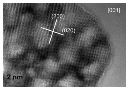
**Der Zeolith mesoporöse Vetter:** Einkristall-artiges Anatas-TiO<sub>2</sub> mit großer Oberfläche wurde durch einfaches Wachstum in Lösung synthetisiert. Die Methode liefert ein kontrollierbares mesoporöses Netzwerk mit bevorzugter Exposition der hochaktiven (001)-Ebenen (siehe TEM-Bild) und kann problemlos auf die Synthese anderer mesoporöser Einkristalle mit Anwendungen z. B. in der Katalyse und Energiespeicherung übertragen werden.
